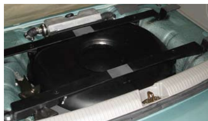
スベアタイヤ形状のLPG容器。欧州では当たり前に使われているが、日本では規制が絡み使用不可
